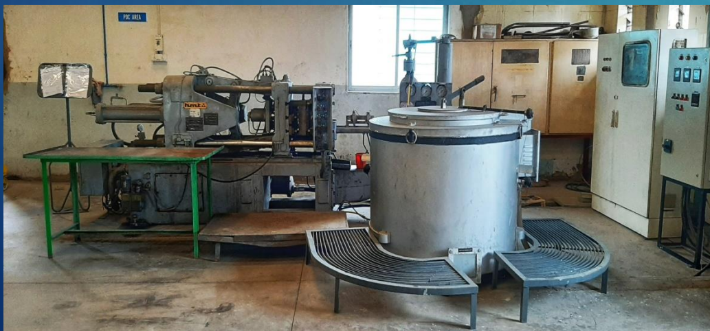
YIZUMI 180 TON DIE CASTING MACHINE
